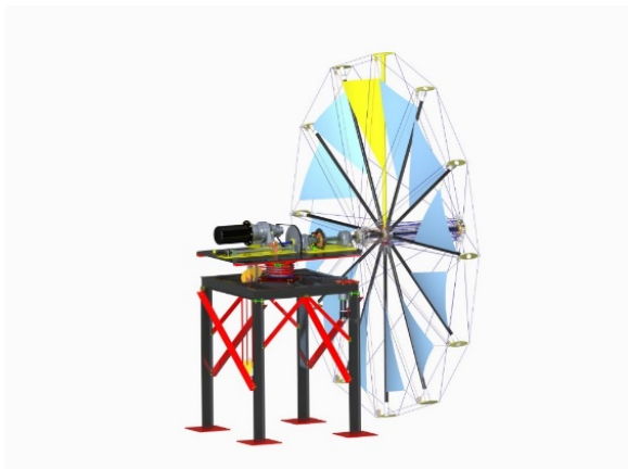
Abb. 3: CAD-Modell des unverkleideten 4m-Prototyp mit ausgerollten Segeln
